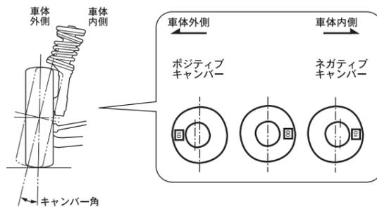
△注意 キャンバーワッシャを使用するナックルボルトとナットは、付属しているものを必ずご使用下さい。純正を使用すると、ネジの掛かりが少ない為、規定トルクが掛からず、脱落の可能性があります。
